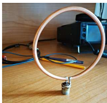
Fig. 12 • La spira captatrice con il connettore saldato
