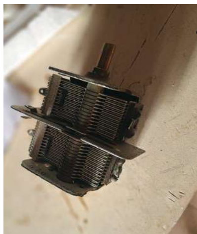
Fig. 8 • Il condensatore variabile da 850 pF per la LM
