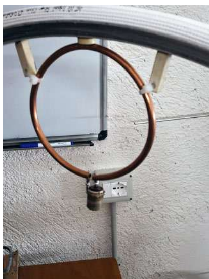
Fig. 13 • Montaggio della spira captatrice sul cerchione
