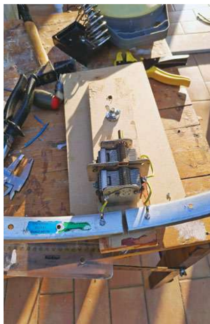
Fig. 11 • Il bloccaggio del cerchione sulla mensola rotante
