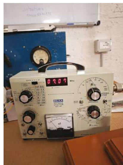
Fig. 16 • Il collaudo con l'analizzatore di antenna Delica AZ1-HF
