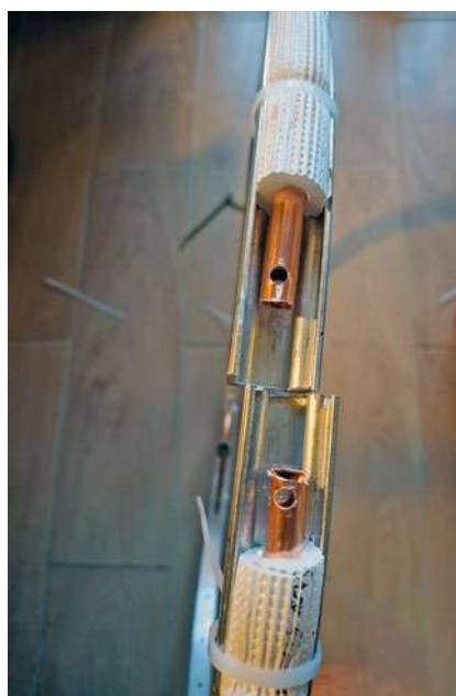
Fig. 10 • Il tubo in rame da 10 mm inserito nel cerchione
