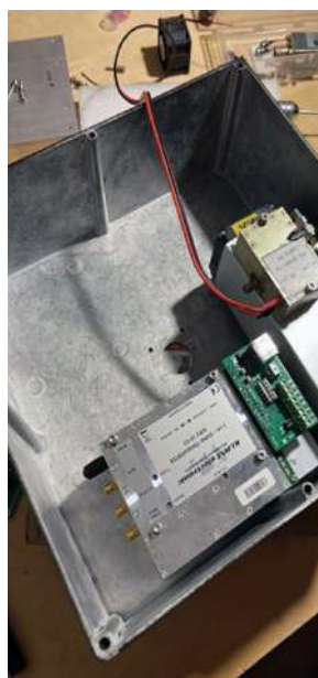
A sinistra: la disposizione del 10G5 e dello SSPA; a destra: l'apertura per l'estrazione dell'aria calda del dissipatore ventilato
