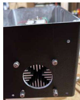
A sinistra: la disposizione del 10G5 e dello SSPA; a destra: l'apertura per l'estrazione dell'aria calda del dissipatore ventilato
